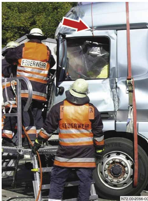
Sicherung der Tür mit Seil
