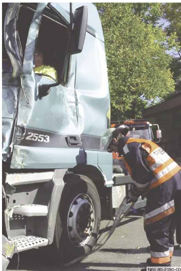
Spanngurt um Rahmen und Fahrerhaus
