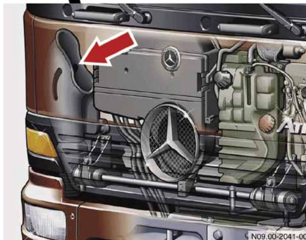
Einspritzstelle CO 2 (Pfeil) der Luftansaugung
