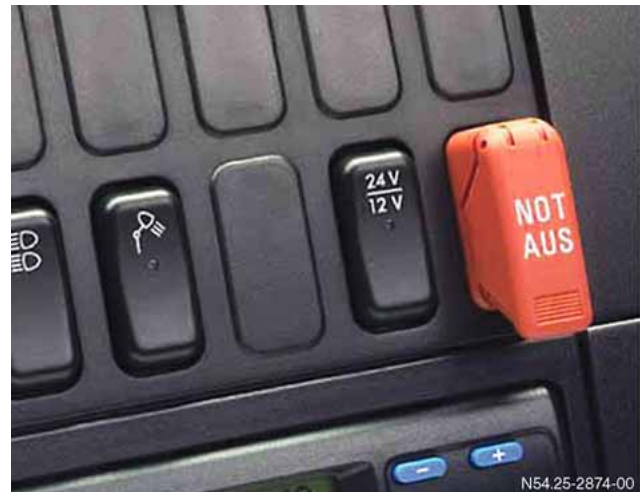
Anordnung Not-Aus-Schalter im Cockpit
