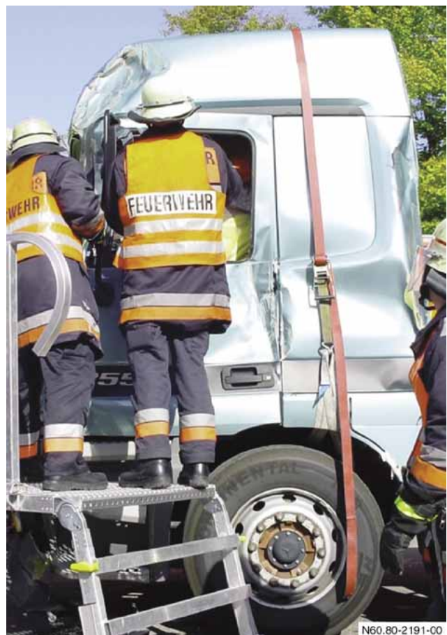
Spanngurt um Rahmen und Fahrerhaus
