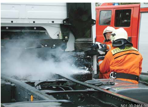
Einblasen von CO 2 in die Luftansaugung
