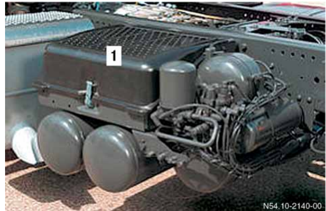
Batteriekasten (1) auf Fahrerseite (Geräteträger)
