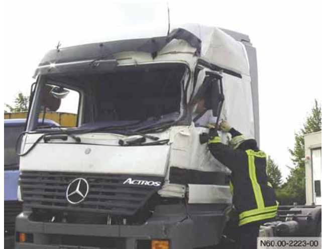
Türen per Hand oder mit leichtem Werkzeug öffnen
