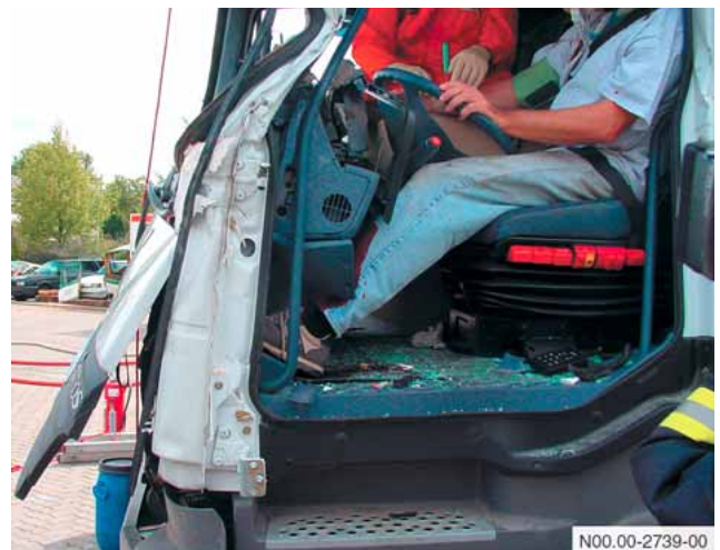
Deformierter Fußraum (Rettungsübung Ludwigshafen 15.09.2001)
