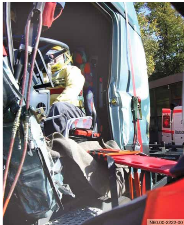
Befreiungsöffnung über die Fahrertür
