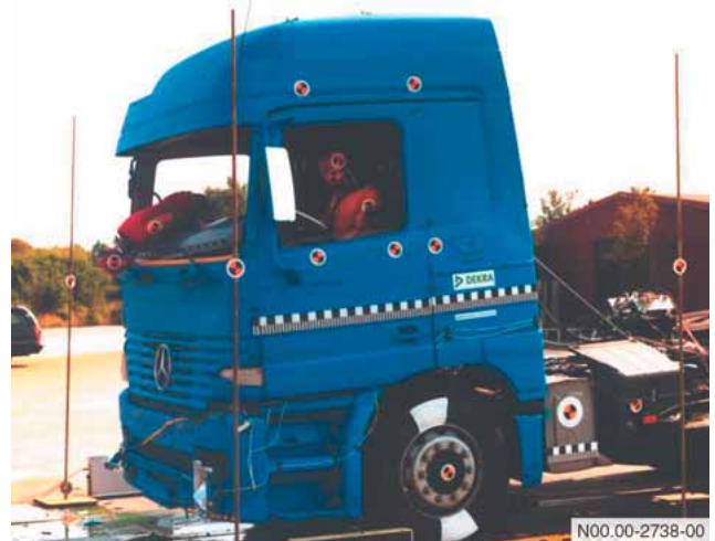
Fahrer angeschnallt, Beifahrer nicht angeschnallt. Aufprall mit 30 km/h auf Pritschenattrappe
