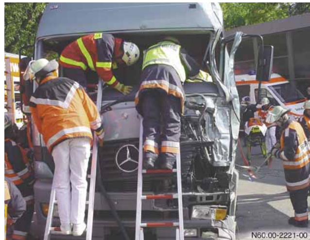
Einstieg über Steckleiterteil
