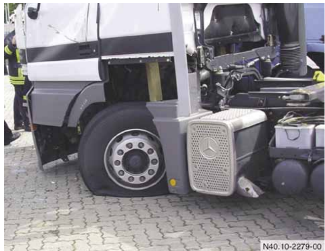
Zum Entlüften des Reifens Ventil herausschrauben
