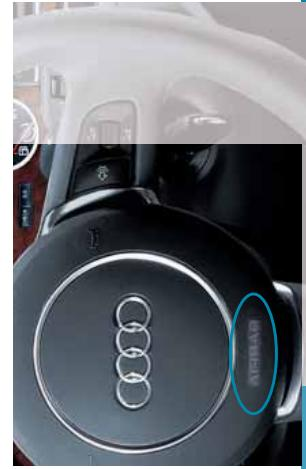
Kennzeichnung des Fahrerairbags auf dem Lenkrad.
